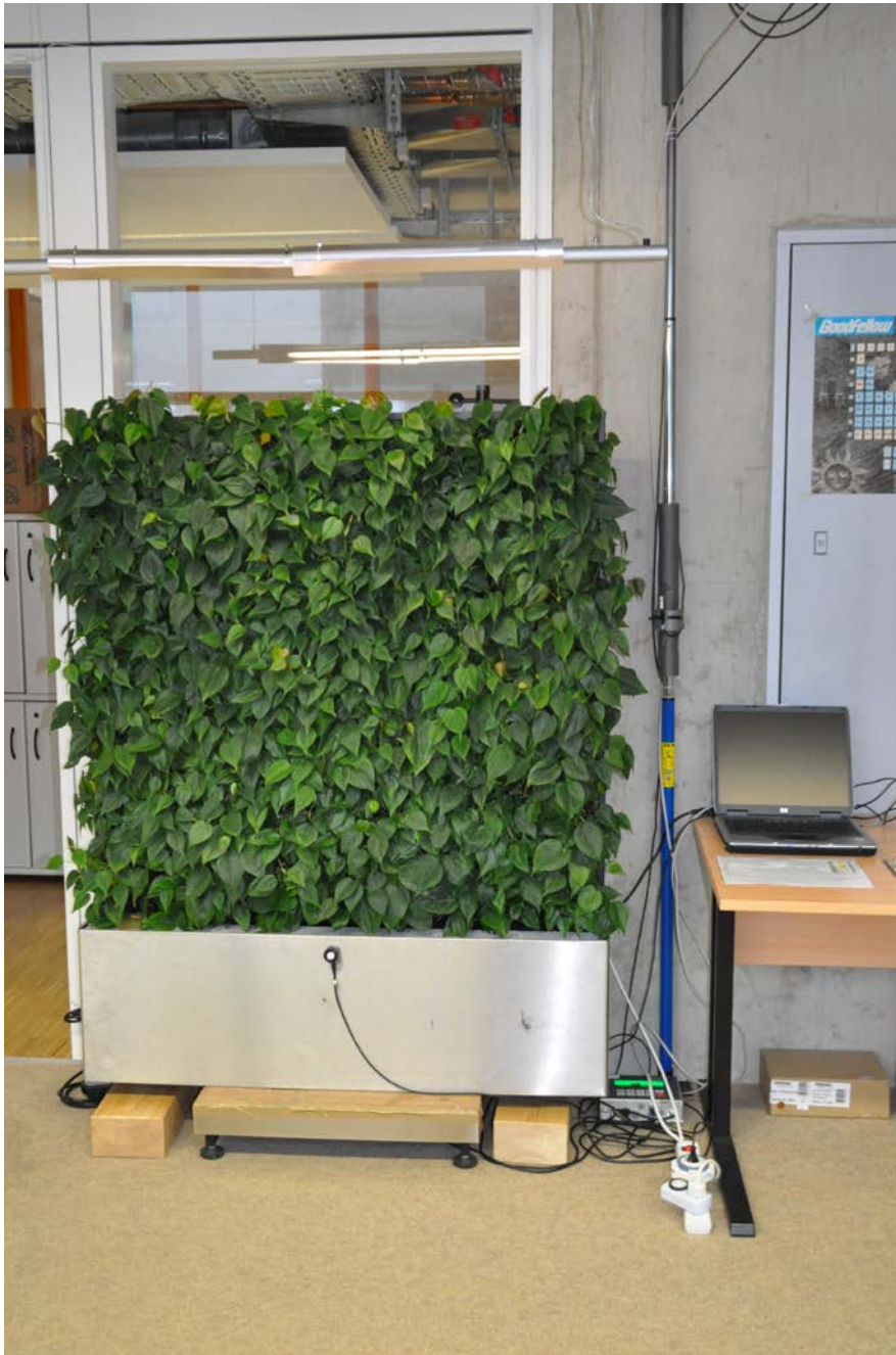
Bild 4: Versuchsanordnung mit Grüner Wand auf der Waage in Raum A.1.02
