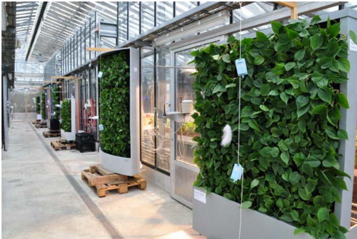
Bild 2: Versuchsaufbau im Gewächshaus - 6 verschiedene, bepflanzte Begrünungssysteme auf Waagen
