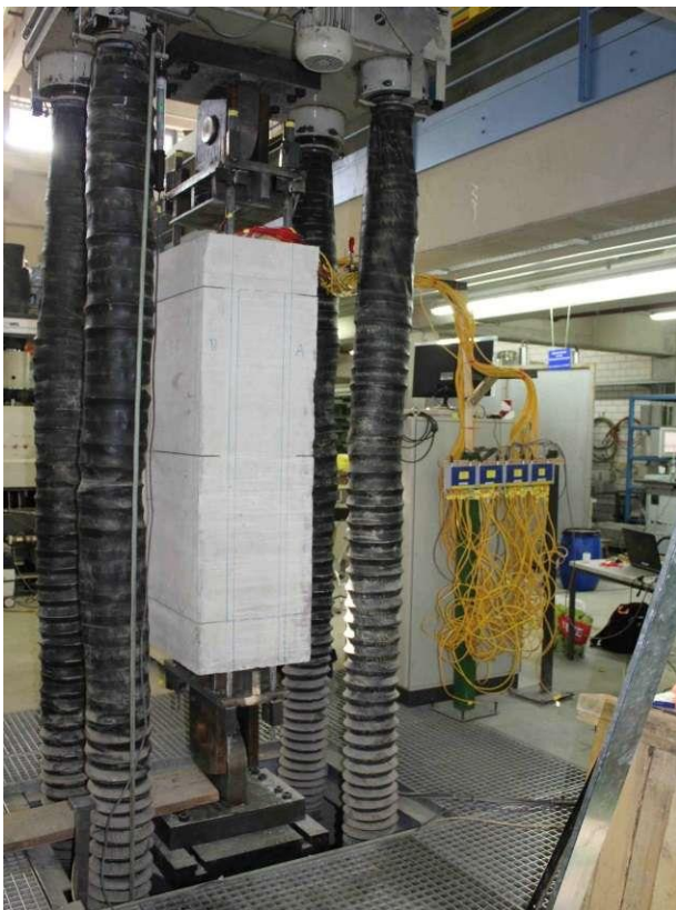
Bild 5: Versuchsstand der Zugversuche mit Probekörper
