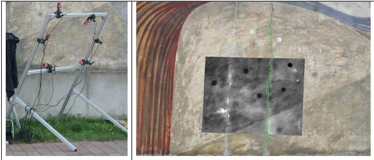
Bild 2: Links: Gestell mit flexiblen Befestigungsmöglichkeiten für die Trackingkameras und mit einstellbarer Neigung. Rechts: Überlagerung eines Thermogramms (grau, Bildmitte) mit einem Foto und einem kartierten Riss (grün) am Beispiel eines Fassadenbereiches mit Referenzmarkern am Wandbild in Cobbelsdorf.
