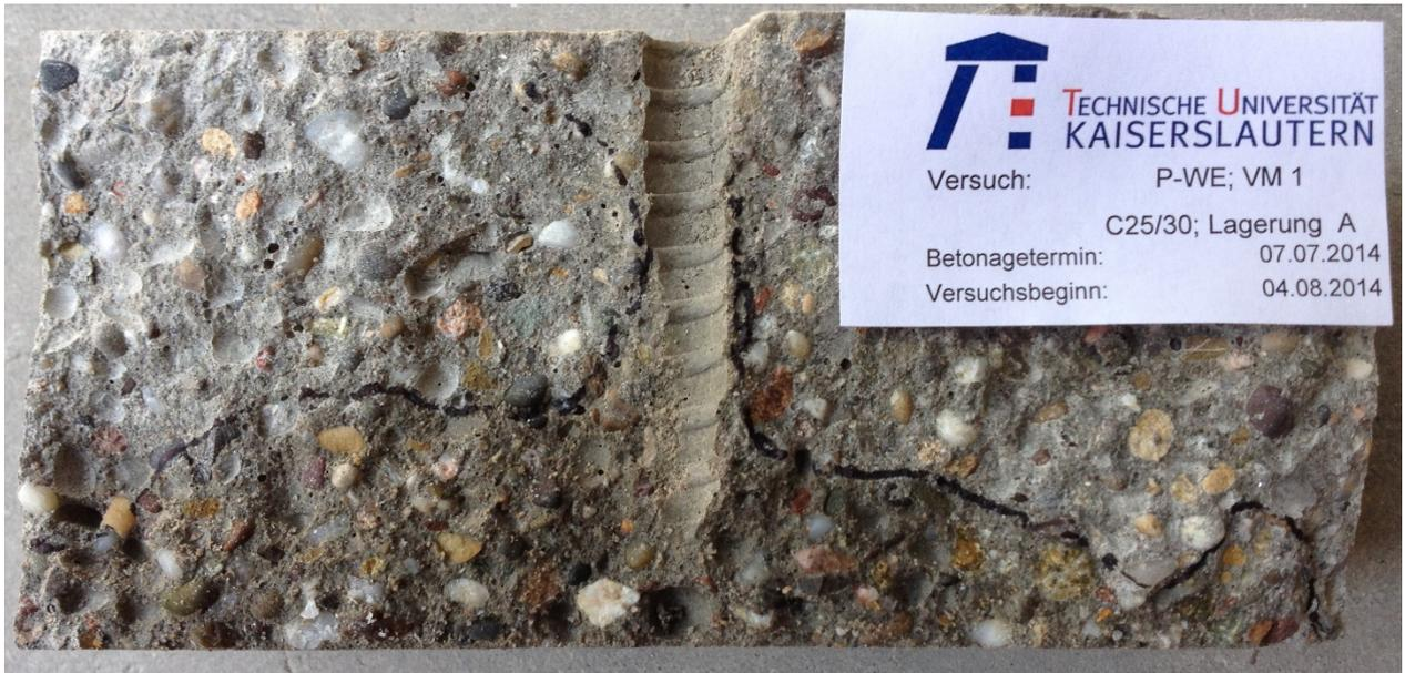
Abbildung 2: Prüfung der Wassereindringtiefe im Bereich des Verbindungsmittels (NC), jpeg
