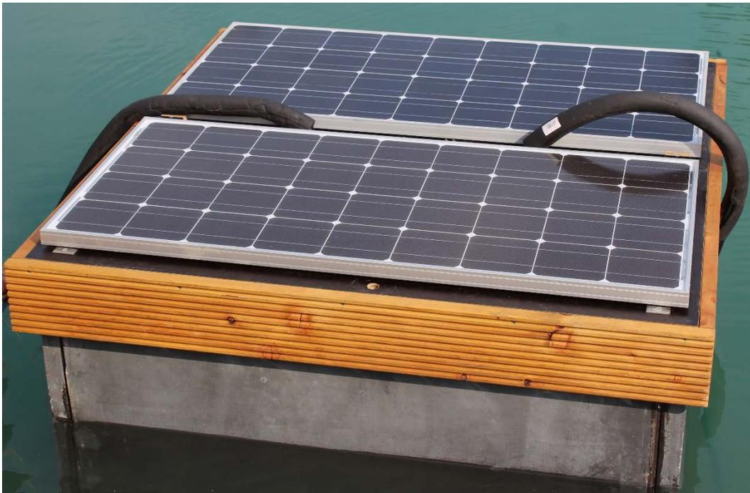
Abbildung 5: Großdemonstrator im Wasser mit Anlagentechnik zur autarken Stromversorgung der Messapparatur, jpeg
