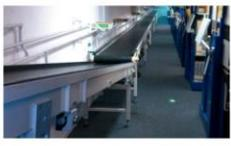
Durch die Re-Aktivierung der vorhandenen Start-Stop-Steuerung werden die Betriebszeiten der Buchförderbandanlage erheblich reduziert. Die Mitarbeiterinnen starten das benötigte Förderbandsegment nach dem Auflegen eines Buches durch Taster. Die für den Transport benötigten Bänder schalten nach Transport des Buches zur Buchausgabe automatisch ab.
