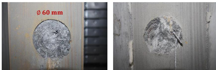
Bild 3: Beide Bruchflächen einer abgescherten, mikrobewehrten Betonnocke
