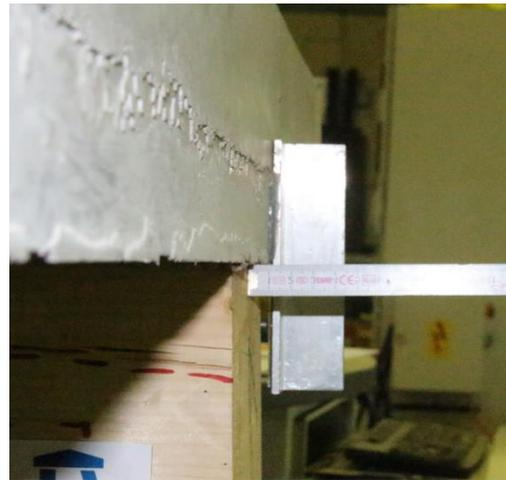
Bild 7: Gegenseitige Verschiebung der Teilquerschnitt am Trägerende in der Simulation (links) und im Versuch (rechts)
