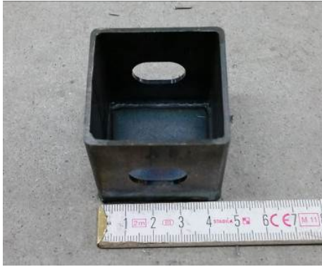
Bild 4: RZ_Bild 4.jpg Spannschloss des Verbindungssystems 2
