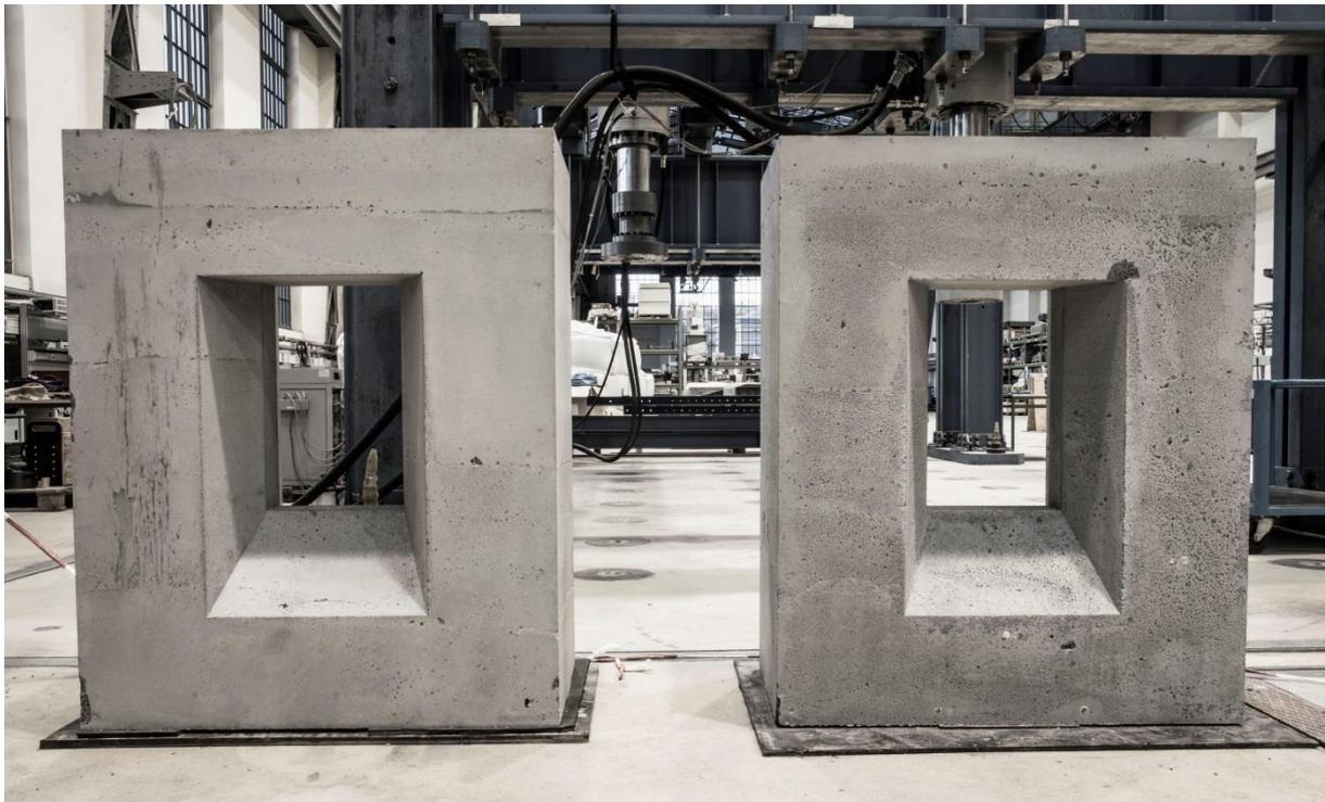
*Bild 4: Prototyp 2, Fensterelemente in ILC mit Trockenrohddichte  $800\text{kg/m}^3$  (links) und  $600\text{kg/m}^3$  (rechts)*
