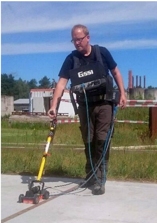
Bild 3: Radarmessungen der Implenia Construction AG auf der REFUND-Testplatte (BAM-TTS, Horstwalde) zur Bestimmung von Plattendicke und Bewehrungslage.
