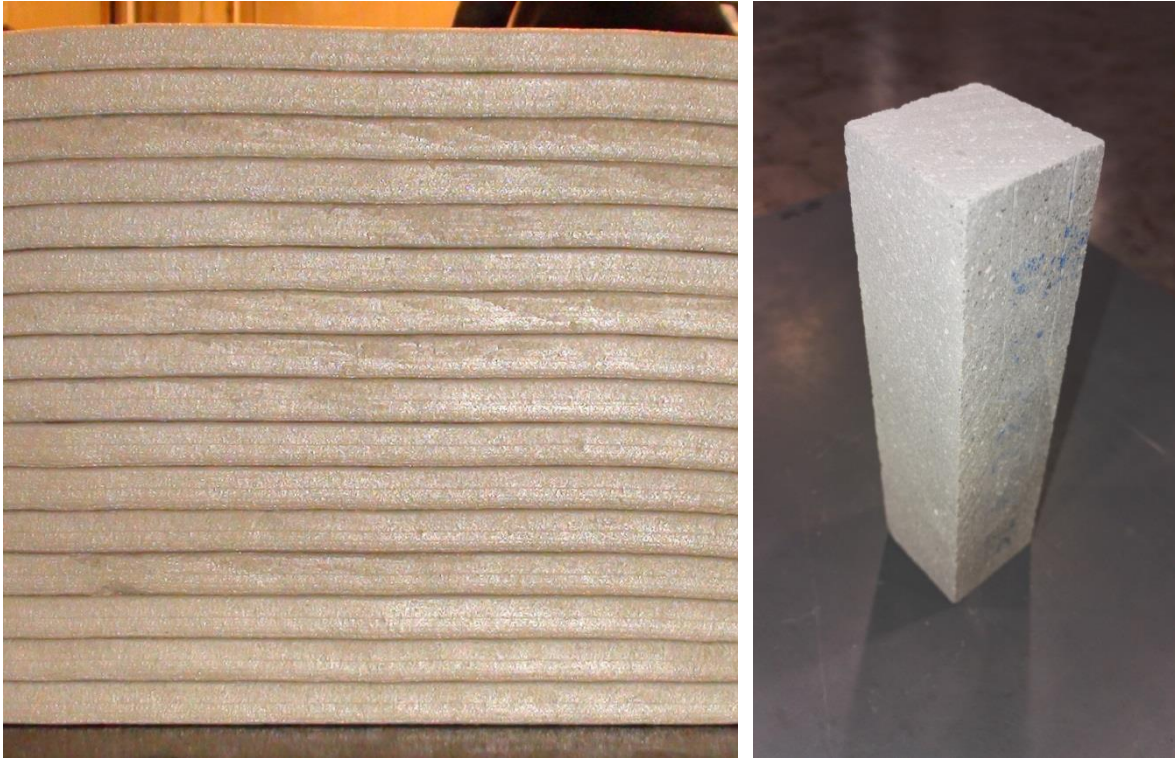
Bild 5: links: Ausschnitt einer gedruckten Beton-Wand, rechts: Probekörper
