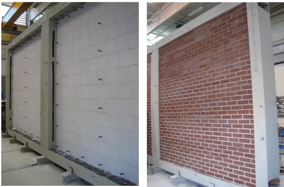
Bild 6 Versuch an der linienförmigen Verankerungsweise (Links: Position der vertikalen Ankerlinien; Rechts: Endzustand des Versuchsaufbaus)
