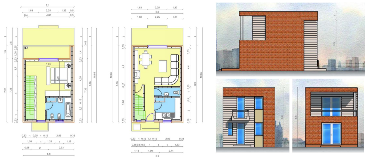
Bild 5 Entwurf des Musterhauses, 2 Etagen, bestehend aus: Eingang, Wohnzimmer, Küche, WC, Treppe, Schlafzimmer, Bad, Ankleidezimmer, Balkon und Terrasse, Bebaute Fläche = 52,51 \text{ m}^2 = 8,9 \text{ m} \times 5,9 \text{ m} , Höhe = 6,8 \text{ m}
