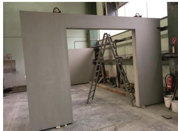
Bild 5: Verformungsbild eines Großkörperversuchs mit Mineralwoll-Dämmung
