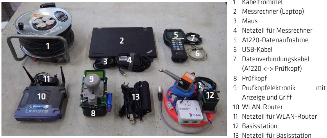
**Abbildung 1: Komponenten des Positionserfassungssystems (UPS-Version 2.3)**
