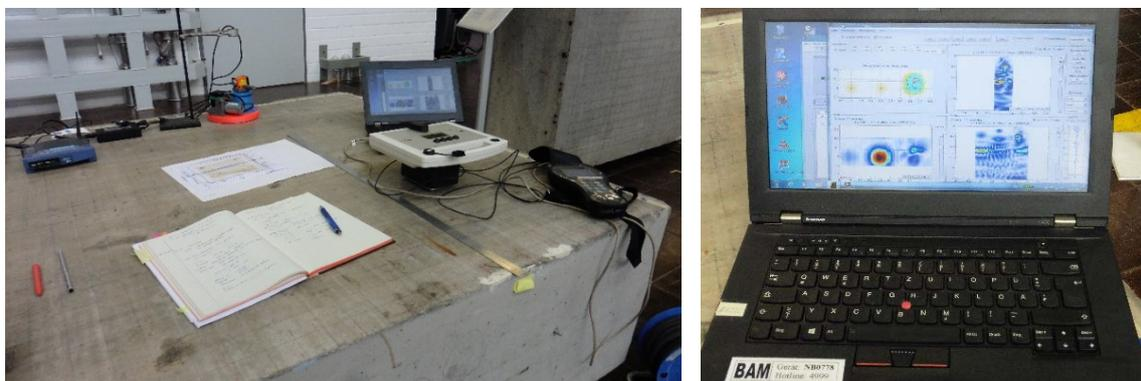
**Abbildung 6: Anordnung der USP Apparatur zur Ortung der Styrodurkugel am FBS1.
