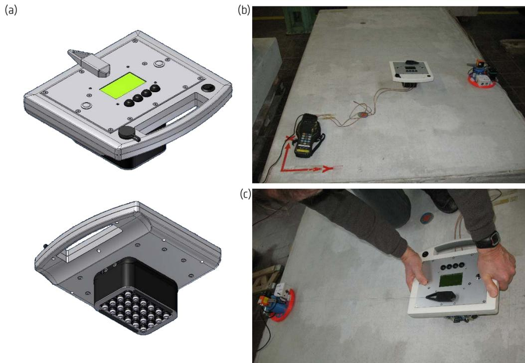
**Abbildung 4: Baustellentauglicher Prüfkopfaufsatz (Neobotix). (a) Konstruktionsansichten, (b) Anwendungstest (UPS-Version 3.3), (c) Detailaufnahme zu Seilaufnahme / -verschluss und Auslösemechanismus**
