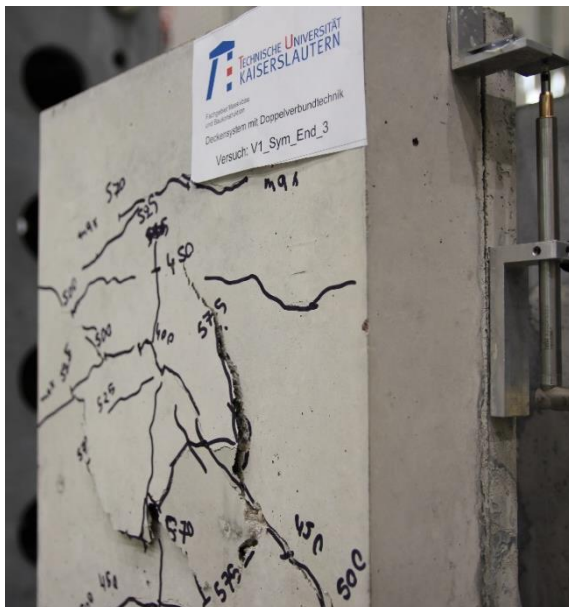
Bild 4: Ausbruchkegel auf der Außenseite (links) und auf der Innenseite (rechts) am Beispiel des Versuchs V1-Sym-End-3
