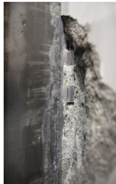
Bild 4: Ausbruchkegel auf der Außenseite (links) und auf der Innenseite (rechts) am Beispiel des Versuchs V1-Sym-End-3
