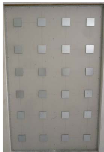
Bild 2: Periodisch beschwerte Gipskarton-Ständerwand in der Prüföffnung zwischen Send- und Empfangsraum ( B \times H = 1,25 \text{ m} \times 2,0 \text{ m} ). Die Beschwerung bestand aus Stahlplatten mit einer Grundfläche von 10 \text{ cm} \times 10 \text{ cm} und einer Masse von jeweils etwa 1,6 \text{ kg} . Das Gitter wies ein Rastermaß von 30 \text{ cm} auf.
