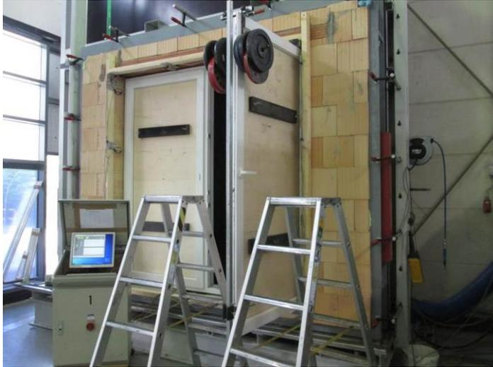
**Abbildung 3** Beispiel eines Bauteilversuches, hier Versuchsaufbau zur Messung der Verformung bei Simulation der vertikalen Nutzlast
