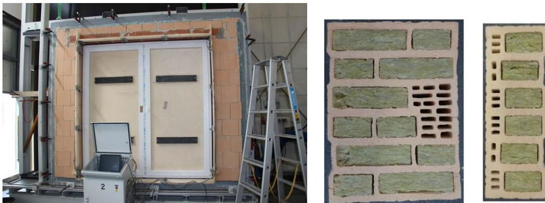
**Abbildung 9** Exemplarischer Wandaufbau mit Fensterelement sowie verwendete Leibungsziegel
