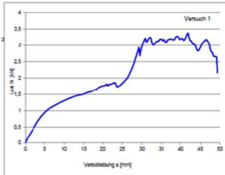
**Abbildung 10** Typisches Kraft-Weg-Diagramm im Rahmen des Kleinteilversuches
