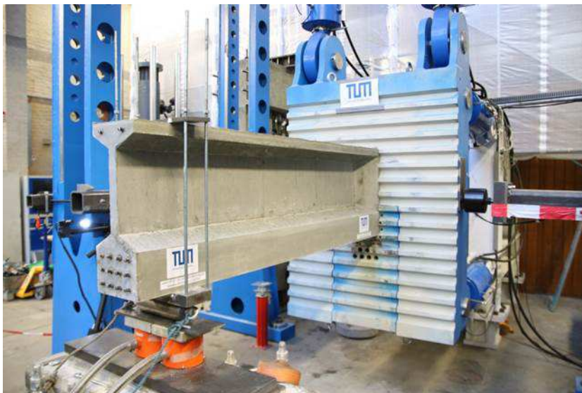
Bild 4: Längsträgerelement im Substrukturversuchsstand.jpg
