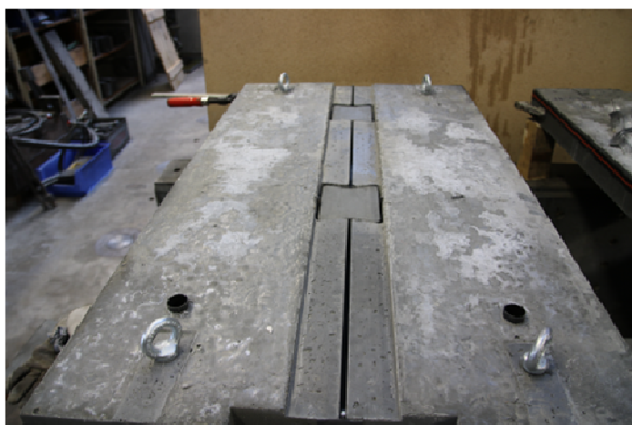
Bild 2: Fügemethode mit schwalbenschwanzförmigen Schubnocken.png
