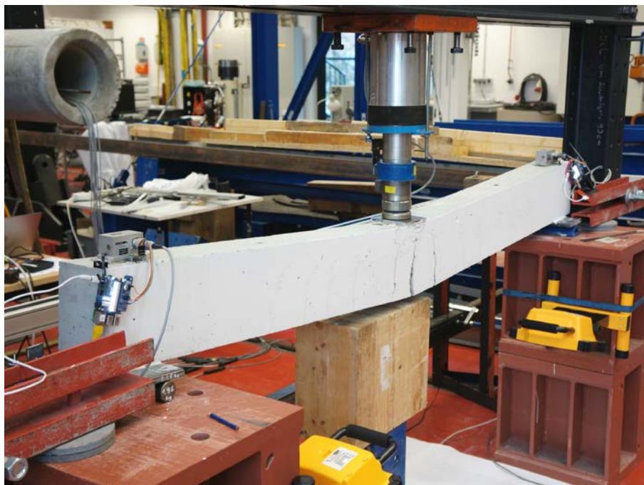
Bild 2: Kurzzeitmessung bei einem 3-Punkt-Biegeversuch an einem Stahlbetonbalken
