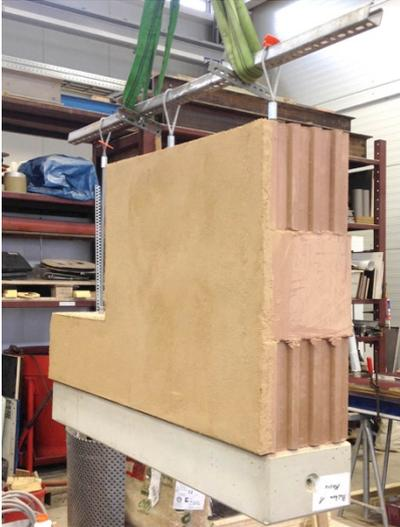
Abb. 2 Hebeversuch Wandelement - Vermeidung von Spannungen im Mauerwerk Variante I: Hubtraverse - keine Querkkräfte auftretend
