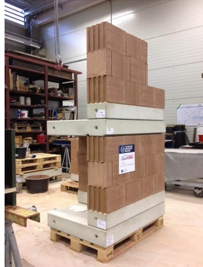
Abb. 3 Zusammenbau und Arretierung der einzelnen Elemente für den Rohbau des Modells
