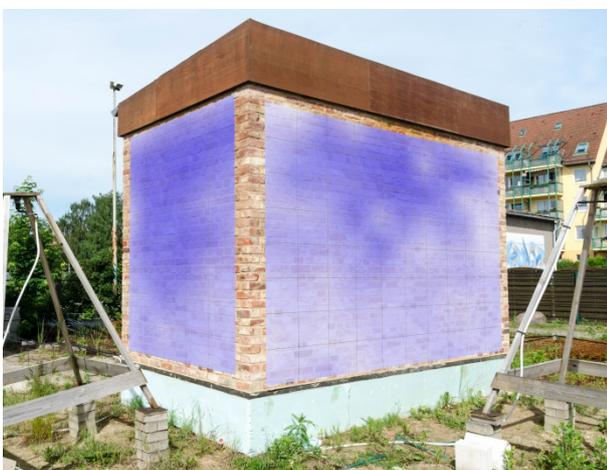
Abb. 7 - Feuchteverteilung auf der Süd- und Ostfassade des aktiv beregneten Versuchsgebäudes 5, A2
