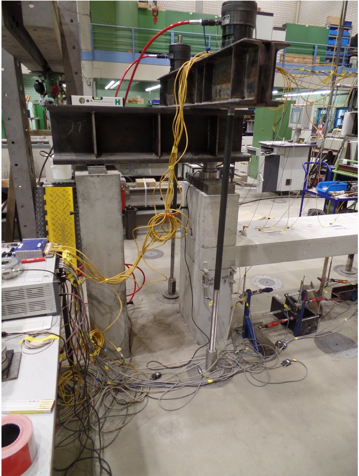
Bild 2: Einspannkonstruktion des linken Auflagers
