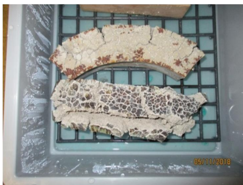
Bild 1 Links Ungeeignetes Injektionsmaterial (Romanzement) in der über Wasserlagerung, rechts nadelförmige Kristalle wachsen im gesamten Gefüge
