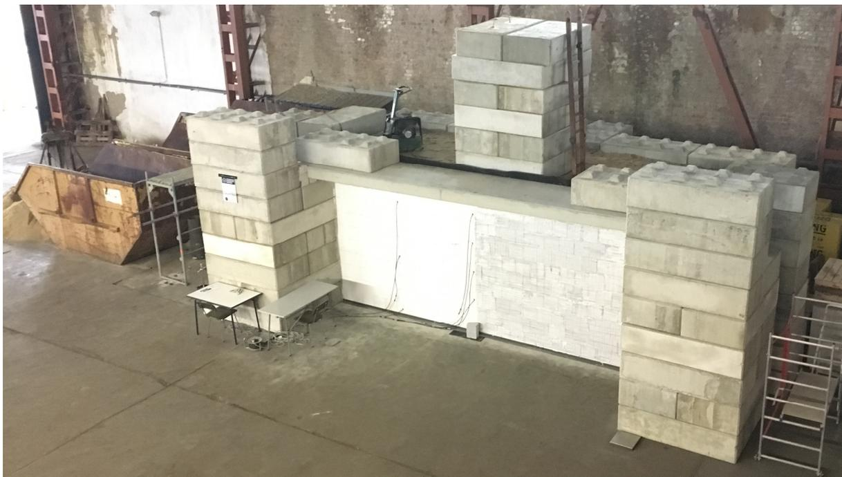
Bild 4 Großversuchsaufbau eines textilbewehrten Kellermauerwerkes unter Erddruck nach Versuchsdurchführung
