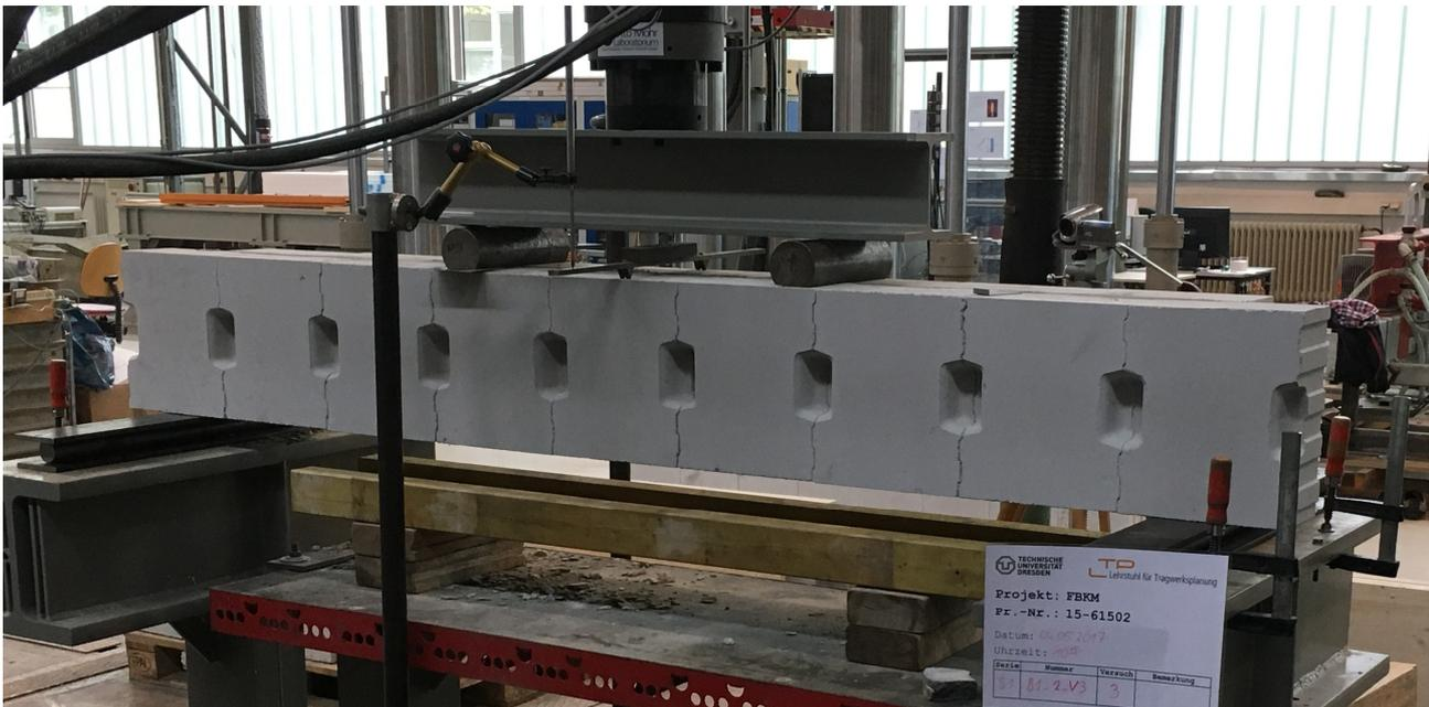
Bild 1 CFK-Textilbewehrter Biegebalken aus Kalksandsteinen
