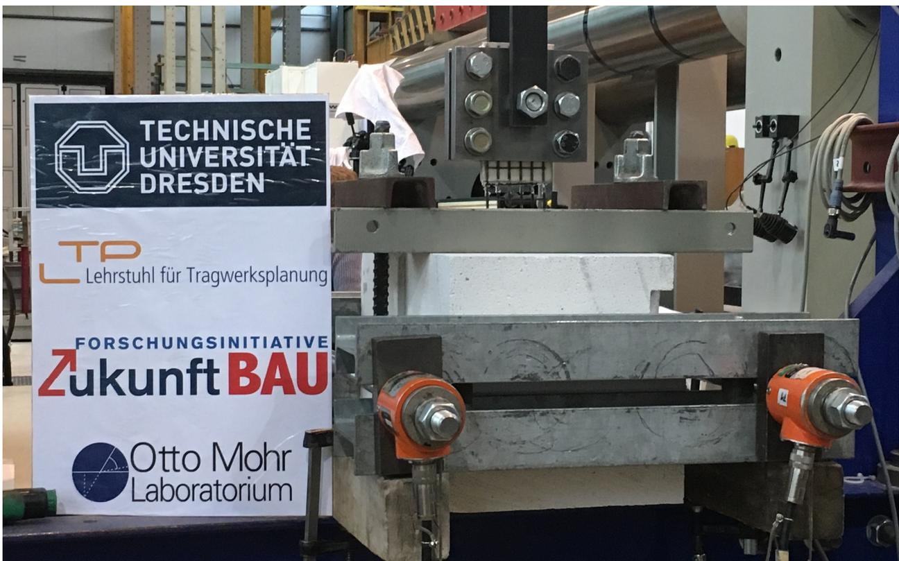
Bild 2 Textilauszugversuch von CFK-Textil aus Porenbetonlagerfuge mit Auflast
