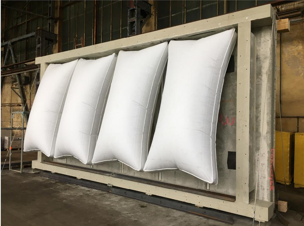
Bild 5 Prüfraumen Luftkissenversuch ohne Versuchswand (Im Einbauzustand füllen die Luftkissen den Zwischenraum voll aus)
