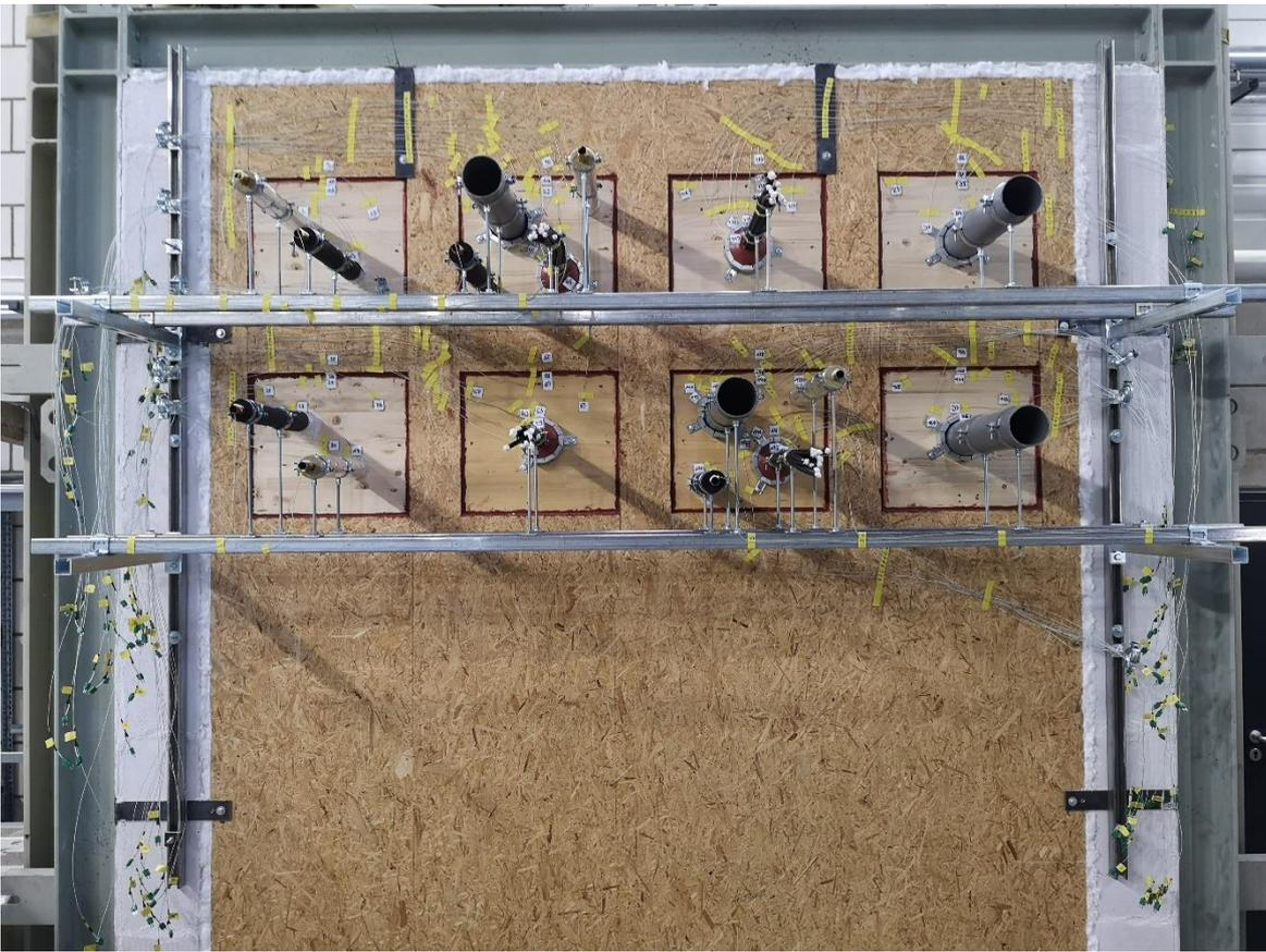
Bild 1: Versuchsaufbau Großbrandversuch, Brettschichtholzmodule mit Abschottungen in einer Holzrahmenwand
