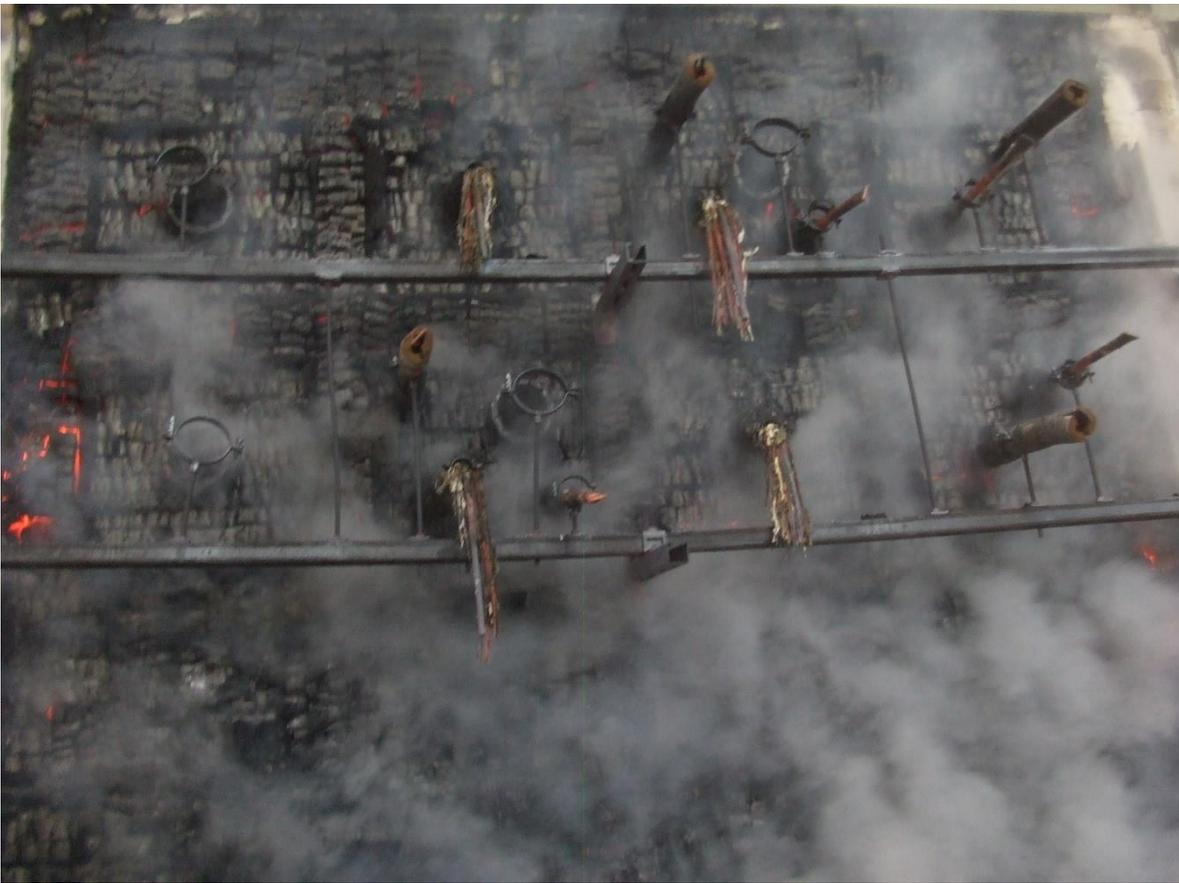
Bild 5: Großbrandversuch, Brettsper Holz wand mit Leitungsabschottungen beim Löschvorgang
