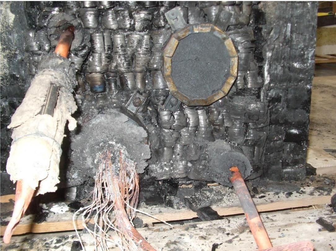
Bild 6: Brandseite eines Brettschichtholzmoduls mit Leitungsabschottungen nach dem Versuch
