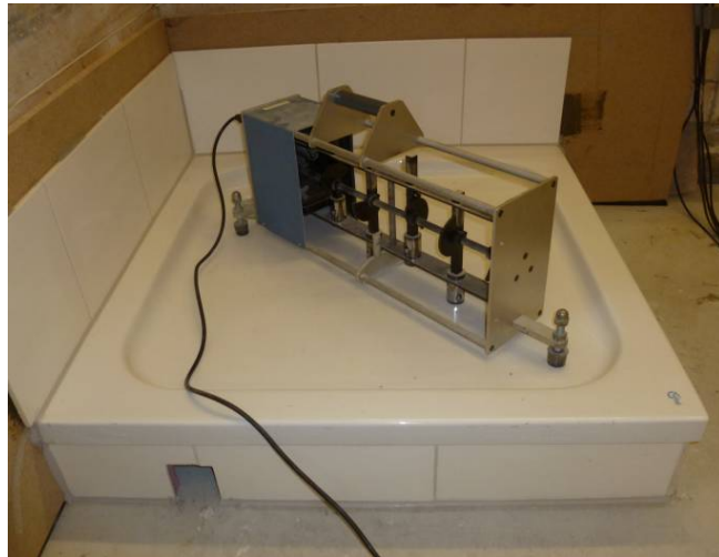
Bild 3: Anregung einer fertig eingebauten und verfliesen Duschwanne mit einem Norm-Trittschallhammerwerk.
