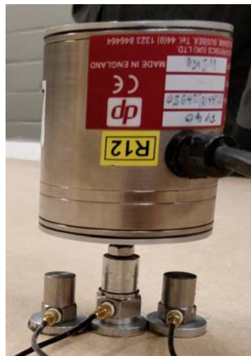
Bild 2: Ermittlung der Eingangsdmittanz eines Bauteils durch Anregung mit einem elektro-dynamischen Schwingungserreger (Shaker). Zur Messung der einwirkenden Kraft und der resultierenden Schnelle werden ein piezoelektrischer Kraftaufnehmer und zwei Beschleunigungsaufnehmer (links und rechts von der Anregungsstelle) eingesetzt.
