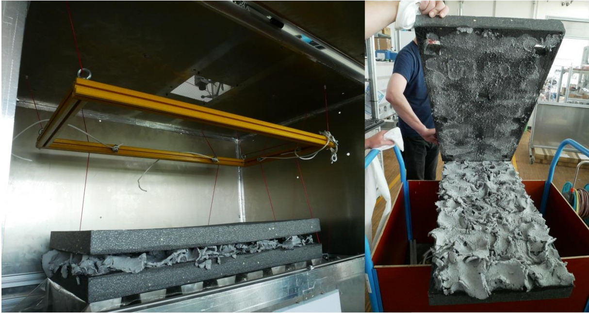
Bild 5: Entklebte EPS-Platte nach Mikrowellenbestrahlung im MAC-RTM bei einer Oberflächentemperatur des Klebstoffes von 80 °C
