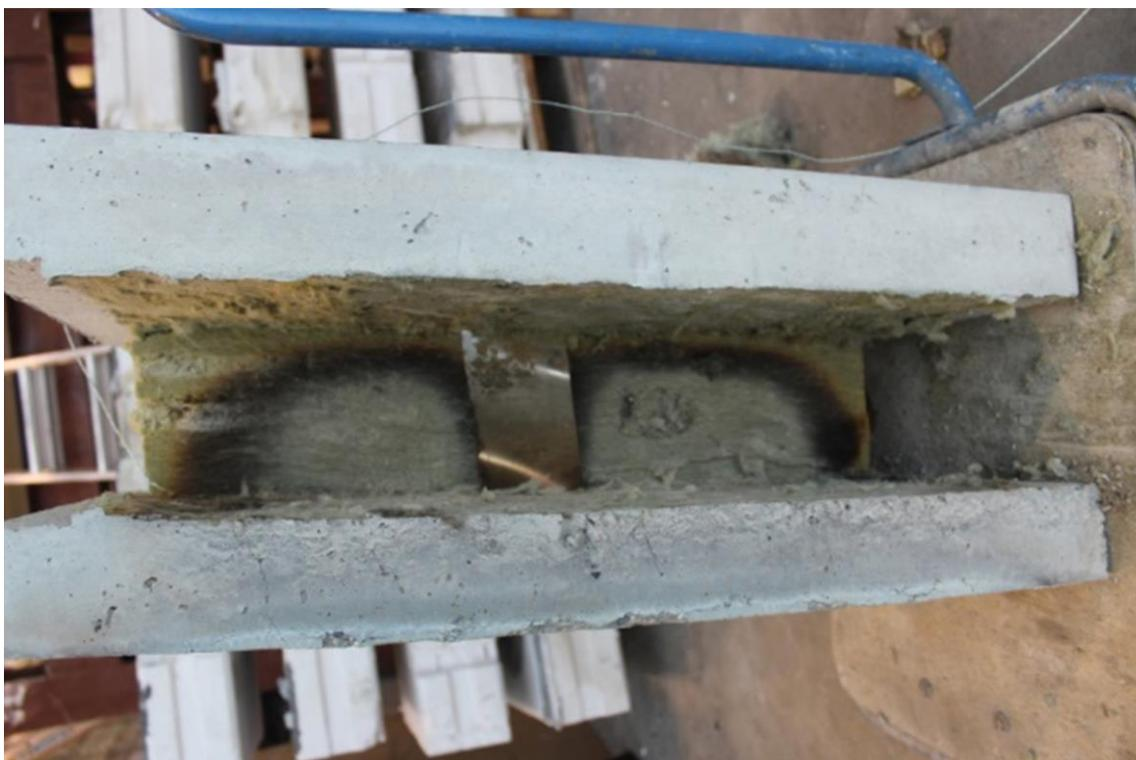
Abbildung 6: Thermische Beschädigung des Mineralwolle.jpg
