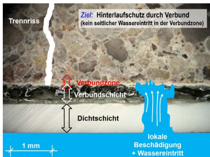
Bild 3: Schematische exemplarische Darstellung der Funktion von FBV-Systemen [Quelle: DBV-Heft 44]
