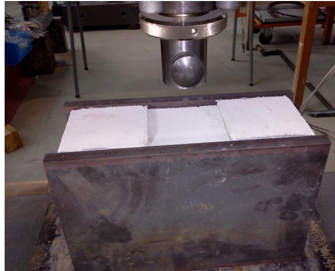
Bild 7 Modifiziertes Prüfverfahren B mit aufgeklebten Stahlplatten vor der Lasteinleitung links und nach dem Bruch rechts
