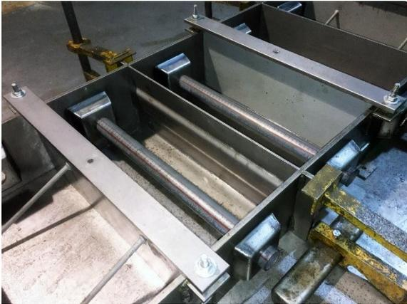
Bild 8 Schalung für RC-Beton-Halbsteine
