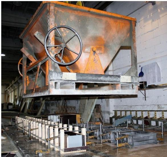
Bild 10 RC-Balken, Betonier-Vorgang
