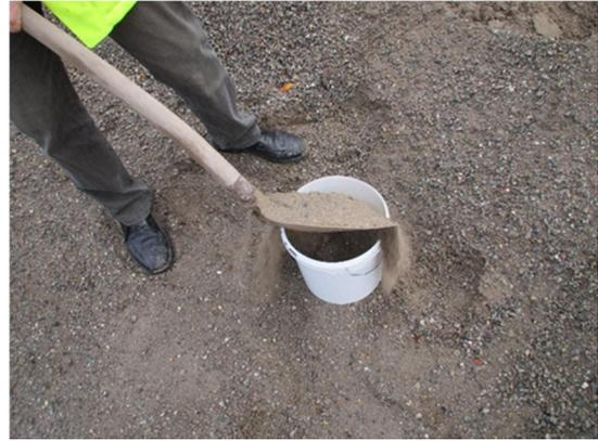
Bild 7 *Probenahme vom Haufwerk 0/16 mm Betonbruch auf dem Betriebsgelände der Firma Heim Deponie & Recycling GmbH*
