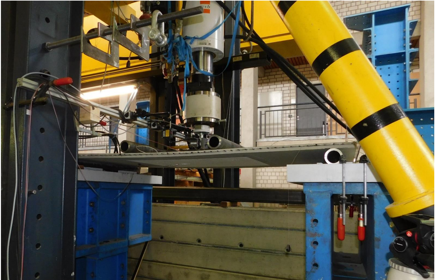
Bild 6: Abb61_Plattenversuche.jpg Versuchsaufbau für die 4-Punkt-Biegeversuche an den textilbewehrten Platten
