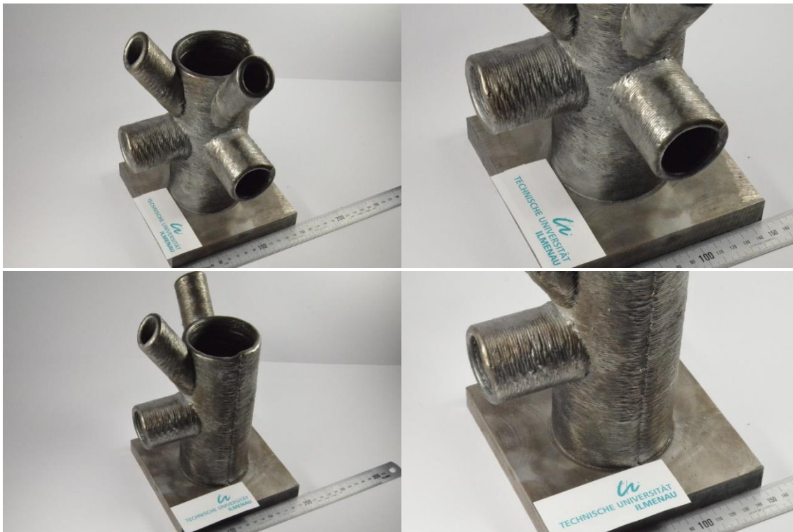
Abbildung 1: additiv hergestellter Obergurtnoten mit Vertikal- und Diagonalstäben
