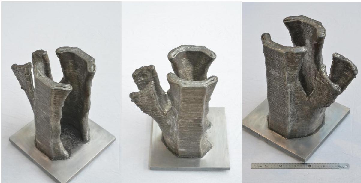
Abbildung 4: additiv gefertigter, topologieoptimierter 30° Schrägstoß
