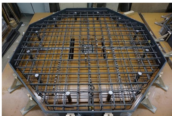
Bild 1: Bewehrungsführung mit Schalung (links) und verwendete Stahldrahtfasern (rechts)
