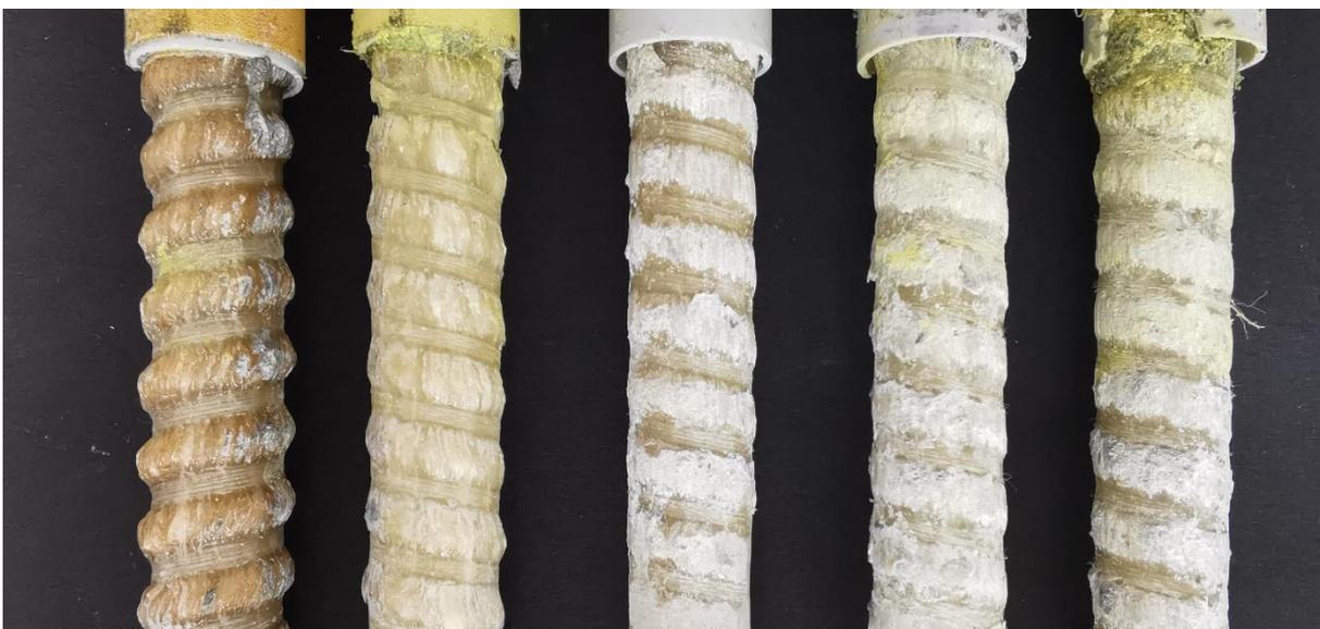
Bild 5: Zeitabhängige Zersetzung der Oberflächenprofilierung von GFK3 bei 60°C. Von links nach rechts abnehmende Auslastung mit zunehmender Standzeit.
