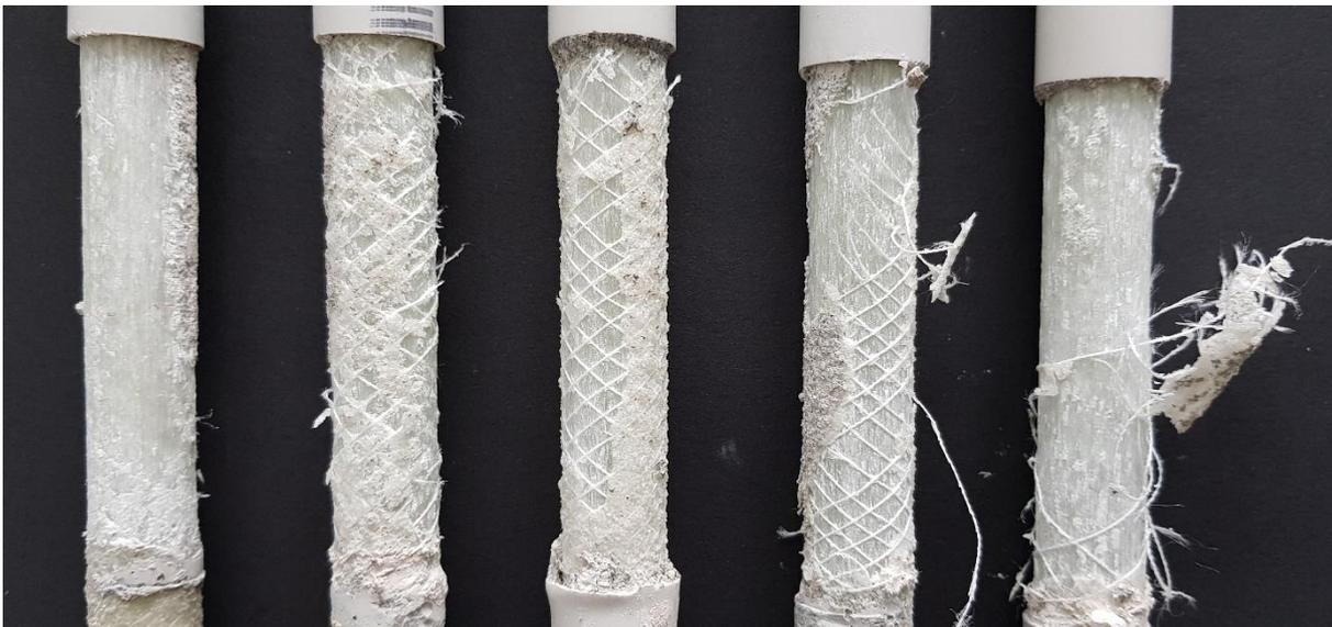
Bild 4: Zeitabhängige Zersetzung der Oberflächenprofilierung von GFK2 bei 60°C. Von links nach rechts abnehmende Auslastung mit zunehmender Standzeit.
