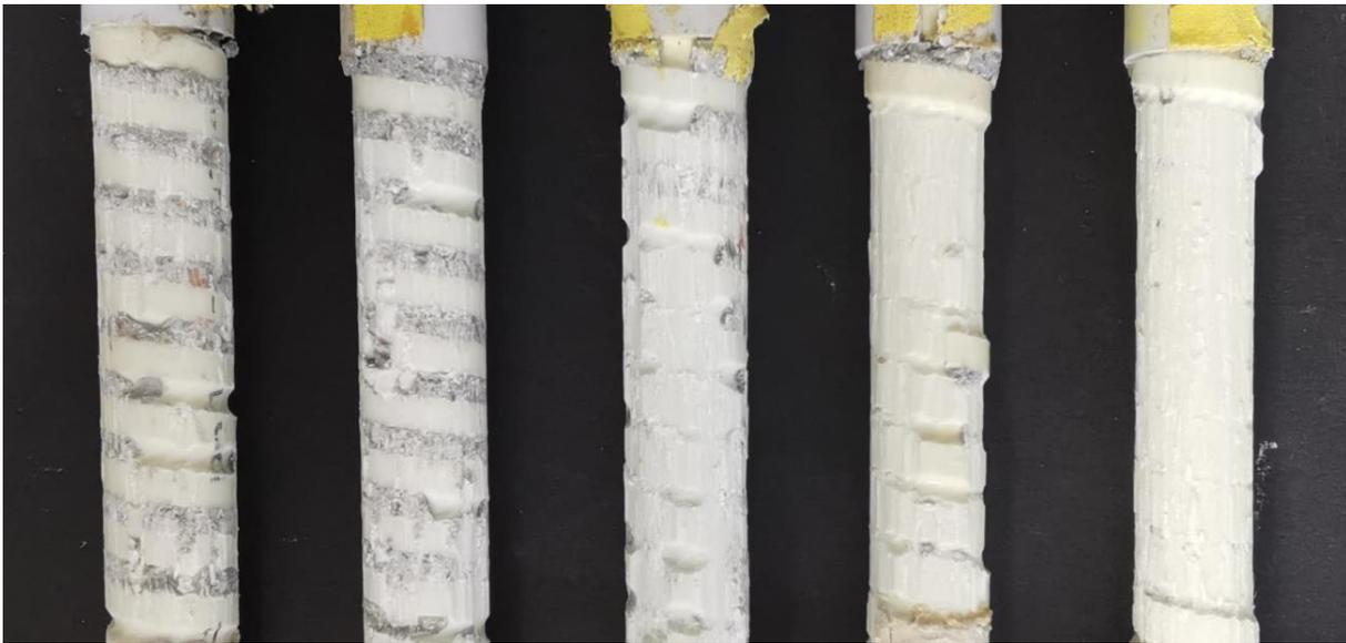
Bild 3: Zeitabhängige Zersetzung der Oberflächenprofilierung von GFK1 bei 60°C. Von links nach rechts abnehmende Auslastung mit zunehmender Standzeit.
