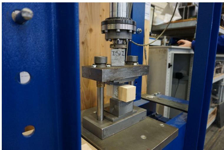
Bild 2: Versuchsaufbau der kleinformatischen Scherversuche
