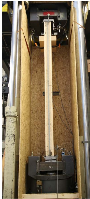
Bild 4: Schematische Darstellung eines zentrischen Bauteilversuchs (links), tatsächliche Darstellung eines exzentrischen Bauteilversuchs (rechts)
