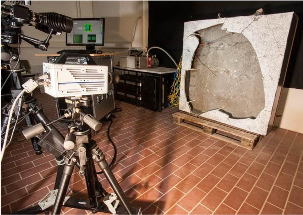
Bild 4: Versuchsaufbau für Unterdruckversuche an Fassadenplatten aus Ultrahochleistungsbeton
