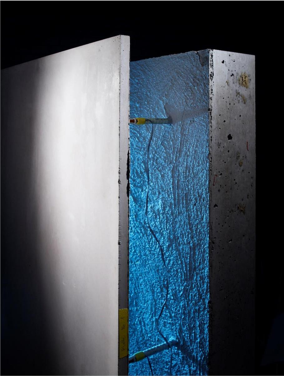
Bild 1: Unbewehrte Ultrahochleistungsbeton Fassadenplatte
