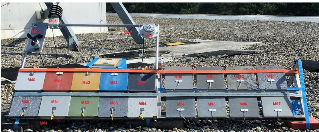
Bild 3: Versuchsstand zur Ermittlung der Oberflächentemperatur von UHPC-Fassadenplatten
