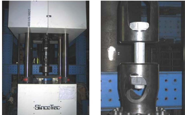
Abbildung 3-1: Prüfmaschine und Zugtorpedo
