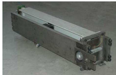
**Abbildung 4-1: Biegeprüfmaschine**
