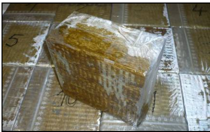
Für die Temperaturwechsellagerung vorbereitete Proben
