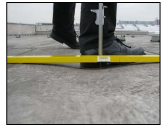
Verformungsmessung bei typischer Belastung
