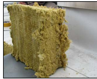
Probe mit stark verminderter Druckbelastbarkeit
