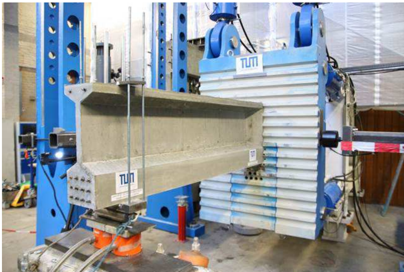
Figure 4: Längsträgerelement im Substrukturversuchsstand.jpg
