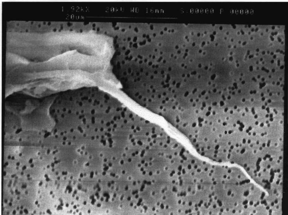
Bild 35: Einbau von Holz-Dämmstoffen; spitz zulaufendes, lungengängiges Faser-Ende im Staub, stationäre Messung
