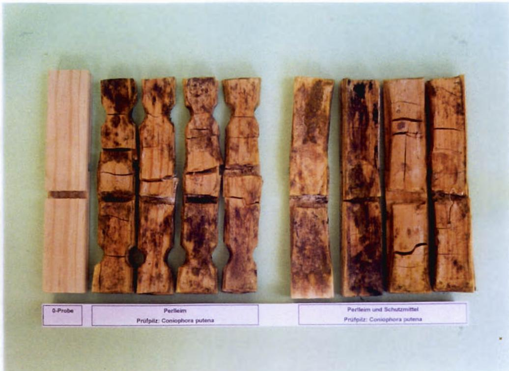
**Abb. 64:** Zugscherproben nach 12 wöchiger Beanspruchung gegen holzerstörende Basidiomyceten, Verleimung: Perleim ohne und mit Schutzmittel, Prüfpilz: *Coniophora puteana*
