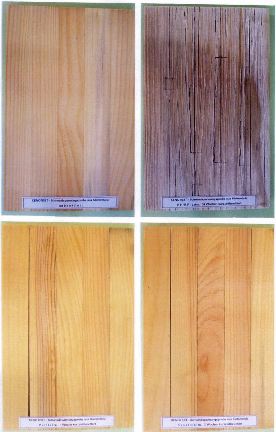
**Abb. 55:** Xenotest-Delaminierungs-Proben mit entleimten Fugen, unbewittert sowie nach 1, 3 bzw. 36 Wochen Kurzzeitbewitterung, Verleimung: PF/RF, Kasein- und Perleim, Holzart: **Kiefer**
