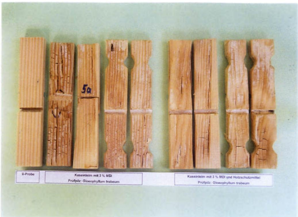
**Abb. 63:** Zugscherproben nach 12 wöchiger Beanspruchung gegen holzerstörende Basidiomyceten, Verleimung: Kaseinleim mit 3% MDI sowie ohne und mit Schutzmittel, Prüfpilz: *Gloeophyllum trabeum*
