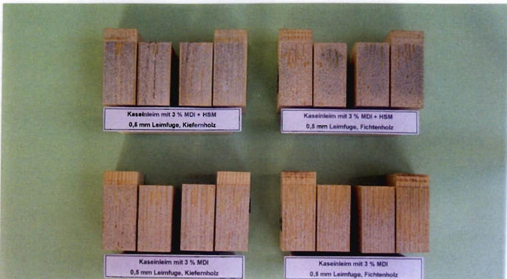
**Abb. 53:** Typische Leimbrüche von Kreuzscher-Proben nach Klimawechsel/Last-Beanspruchung Kaseinleim + 3% MDI sowie mit und ohne Schutzmittel, Holzarten: Kiefer und Fichte
