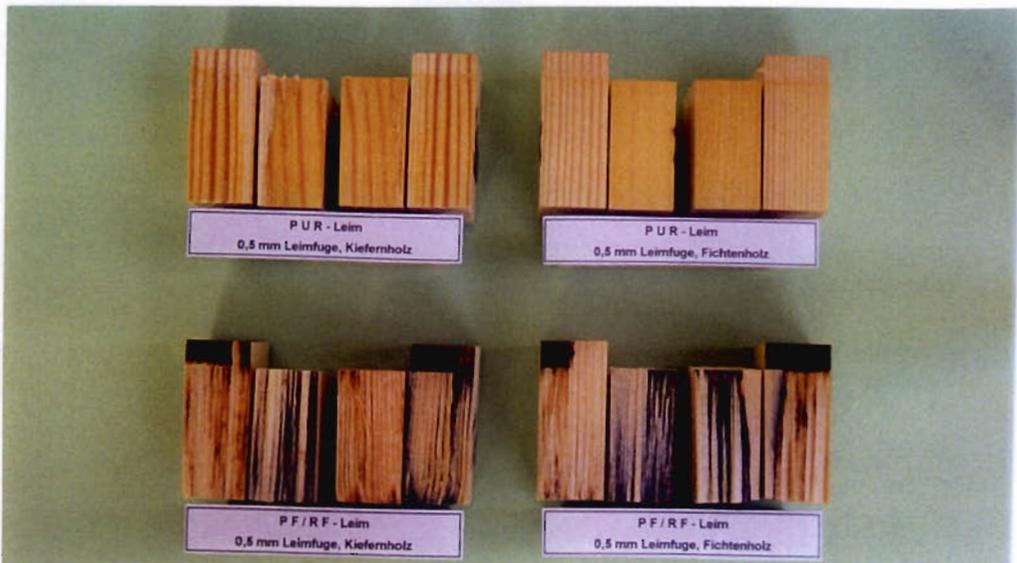
**Abb. 52:** Typische Leimbrüche von Kreuzscher-Proben nach Klimawechsel/Last-Beanspruchung PUR – bzw. PF/RF – Harz, Holzarten: Kiefer und Fichte
