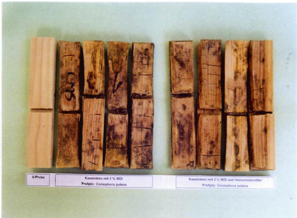
**Abb. 62:** Zugscherproben nach 12 wöchiger Beanspruchung gegen holzerstörende Basidiomyceten, Verleimung: Kaseinleim mit 3% MDI sowie ohne und mit Schutzmittel, Prüfpilz: *Coniophora puteana*
