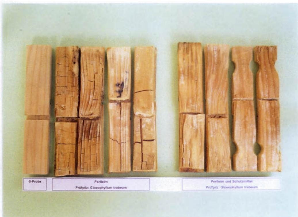
**Abb. 65:** Zugscherproben nach 12 wöchiger Beanspruchung gegen holzerstörende Basidiomyceten, Verleimung: Perleim ohne und mit Schutzmittel, Prüfpilz: *Gloeophyllum trabeum*
