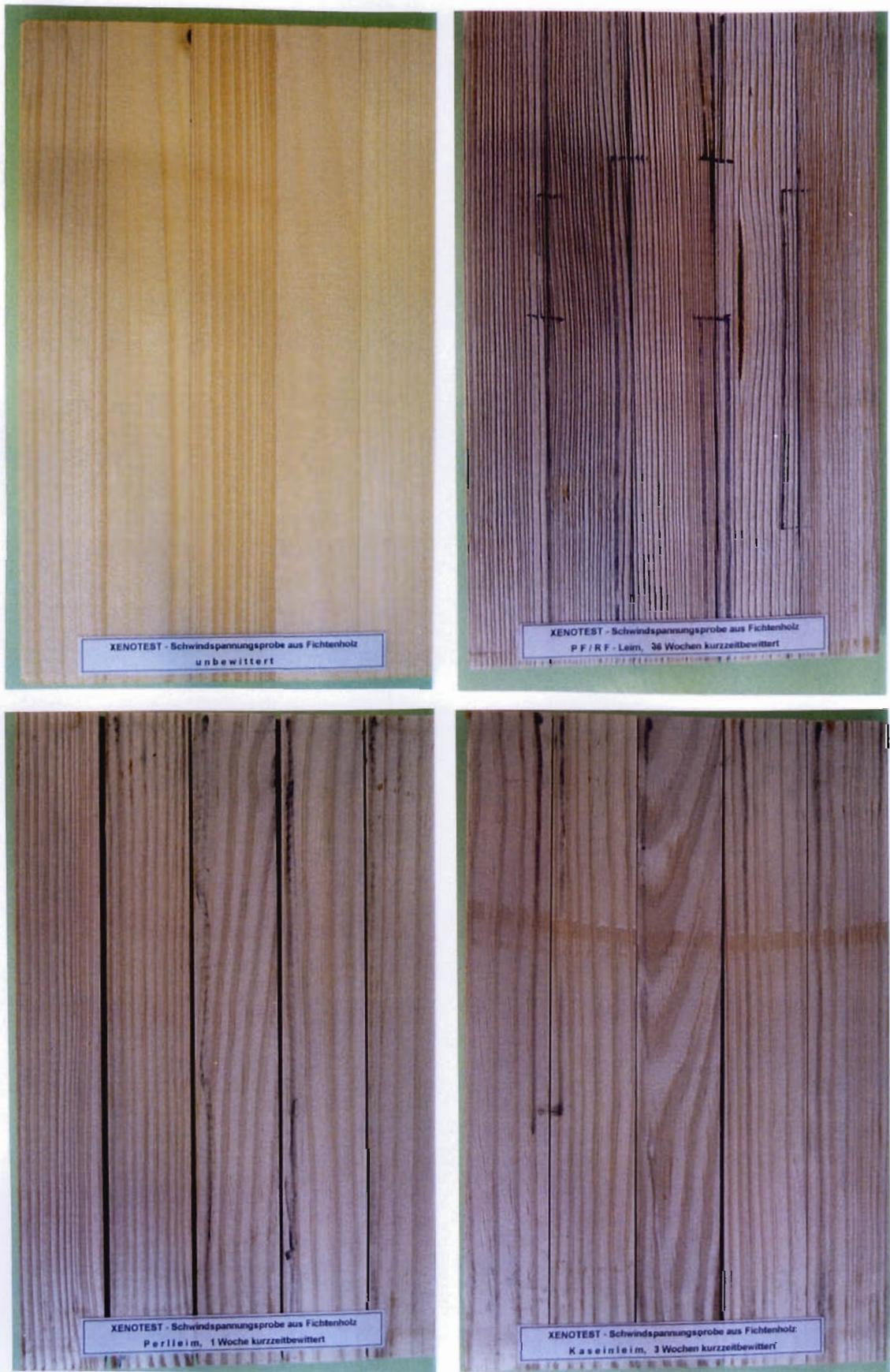
**Abb. 56:** Xenotest-Delaminierungs-Proben mit entleimten Fugen, unbewittert sowie nach 1, 3 bzw. 36 Wochen Kurzzeitbewitterung, Verleimung: PF/RF, Kasein- und Perleim, Holzart: **Fichte**
