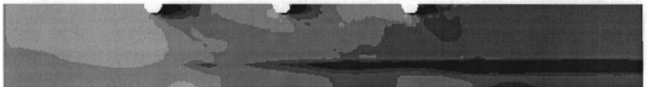
Spannungen in y-Richtung
