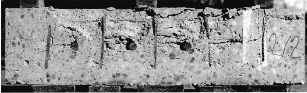
Abbildung 5.18 Verbundfuge des Versuchskörpers 2/2 nach dem Versuch
