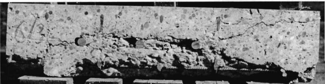
Abbildung 5.21 Verbundfuge des Versuchskörpers 6/3 nach dem Versuch
