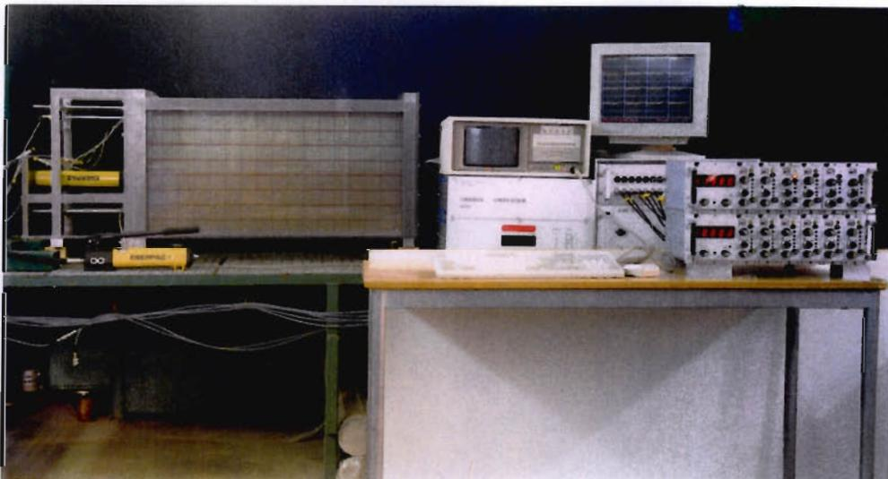
Bild 15. Versuchsstand mit Belastungseinrichtung für statische Versuche
