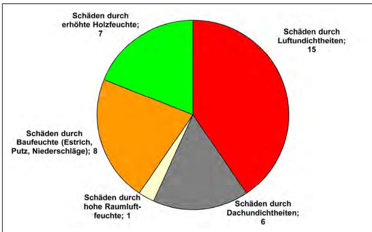
Abb. 12: Übersicht der Schadensfälle pro Ursachengruppe (Mehrfachnennung möglich)
