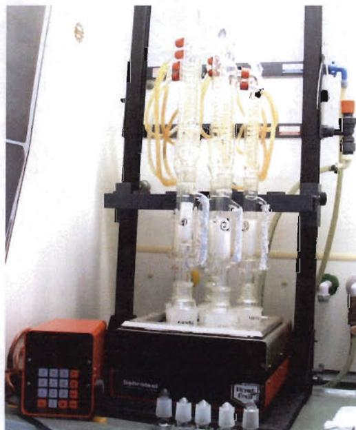
**Bild 12:** Ansicht der für die Holzschutzmittelextraktion verwendeten Extraktionsvorrichtung (Soxhlet-Apparatur)
