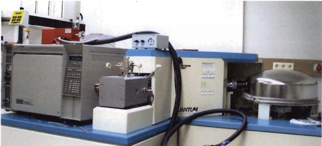
**Bild 11:** Ansichten des verwendeten Gaschromatographen (HP 5890 Serie II) sowie des hochauflösenden Massenspektrometers (Quantum Finnigan MAT)
