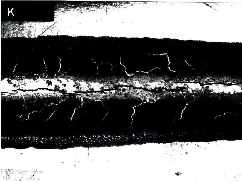
Abb.: 17 a (Aufn.Nr.: K 057) MVT-Probe mit Mittenriss ungeätzt V = 5 : 1
