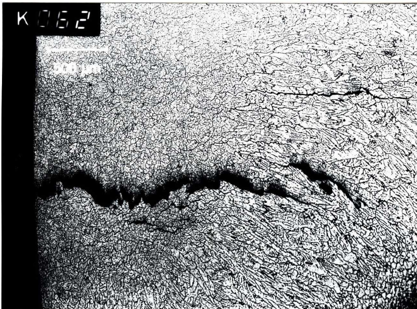
Abb.: 16 d (Aufn.Nr.: K 062) Erstarrungsrisse (ER) im Schweißgut Ätzung: 5% MoO 3 V = 32 : 1
