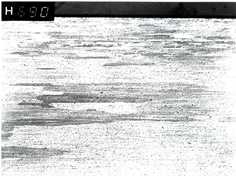
Abb.: 6 b (Aufn.Nr.: H 690) Gestreckte Körner längs zur Walzrichtung mit intermetall. Phasen (schwarze Punkte) Ätzung: 5% MoO 3 V = 16 : 1
