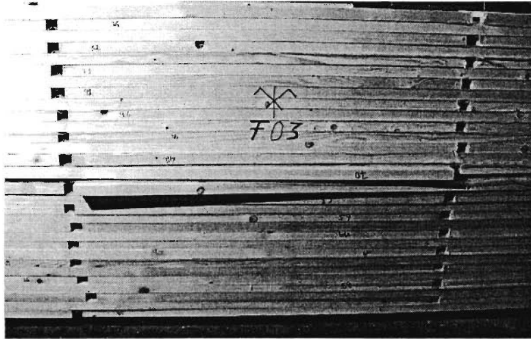
Bild 16 Versagen eines Prüfkörpers infolge des Durchstanzens der Einzellast
