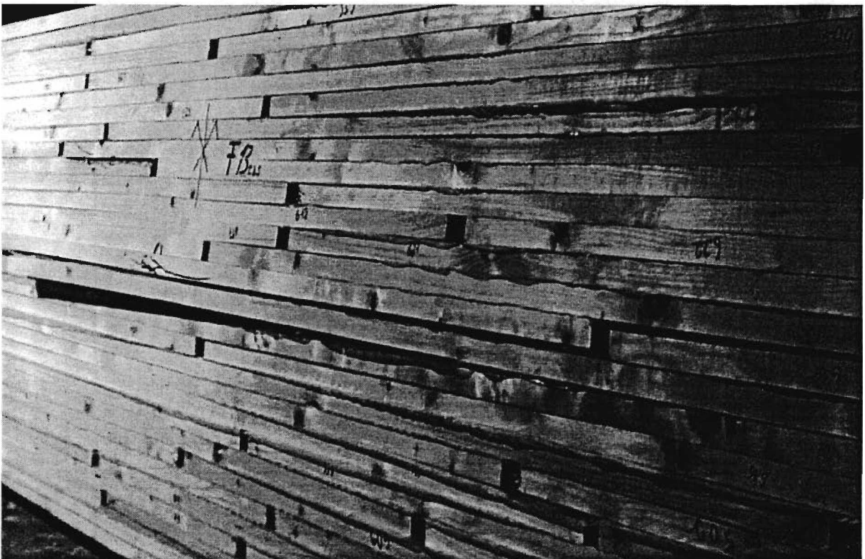
Bild E-6 Prüfkörper mit zufällig verteilten Stößen nach Erreichen der Bruchlast
