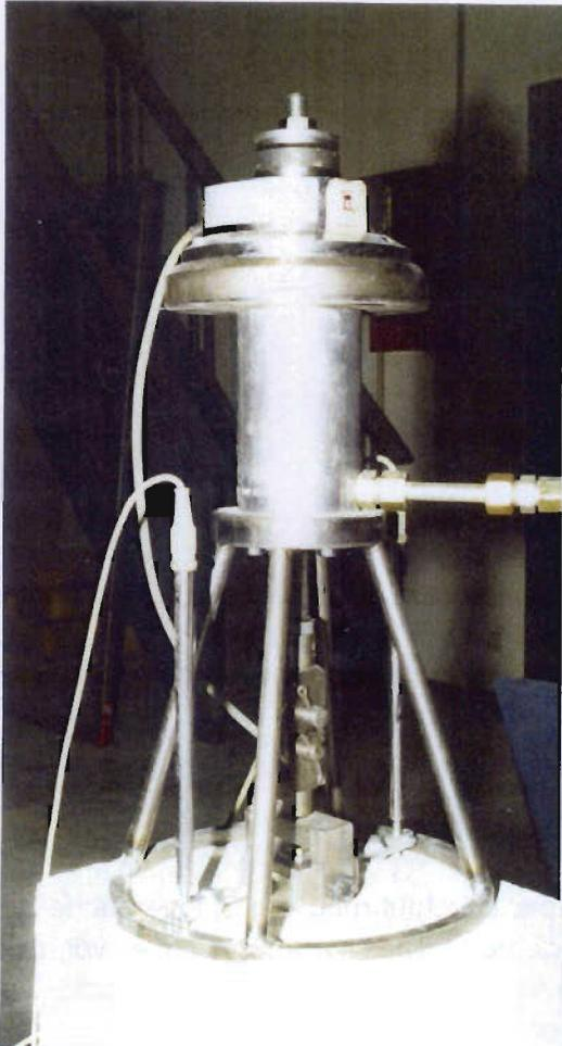
**Bild 5** Aufnahme der für die Dübelzugversuche verwendeten Ausziehvorrichtung
