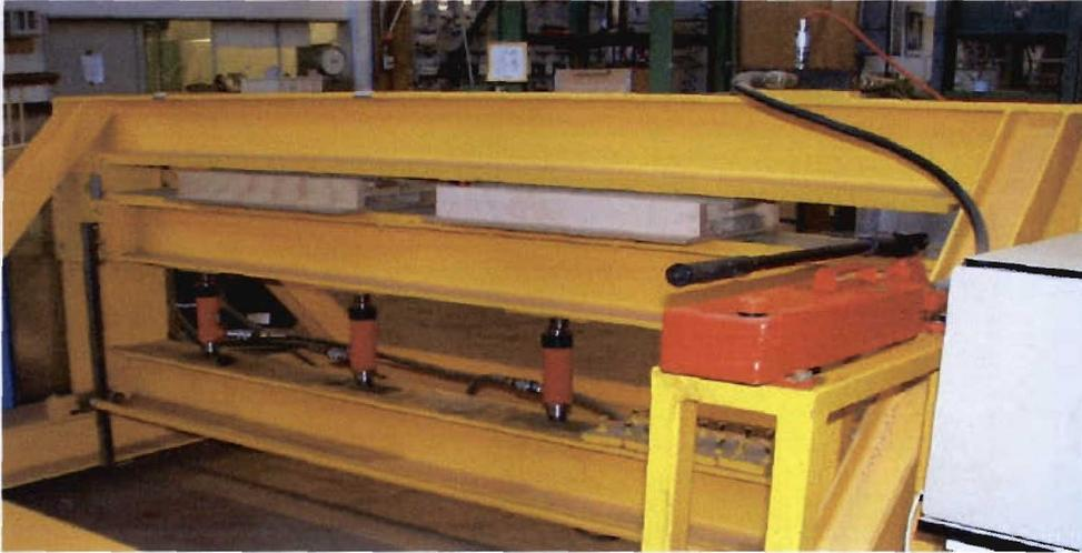
**Abb. 3:** Preßrahmen mit manueller Steuerung des Preßdruckes und eingelegten Verleimungsvorrichtungen
