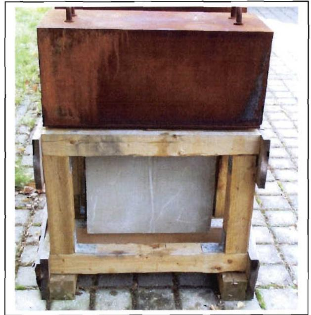
**Abb. 30-31:** Wandelemente im Stellgerüst unter Dauerlast
