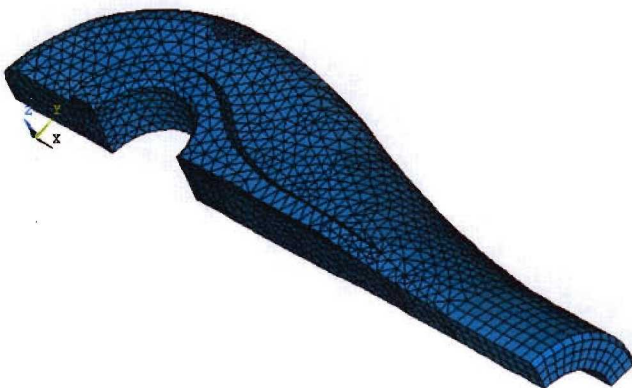
Abbildung 7-7: Elementnetz Gabelkopf DETAN-S 24
