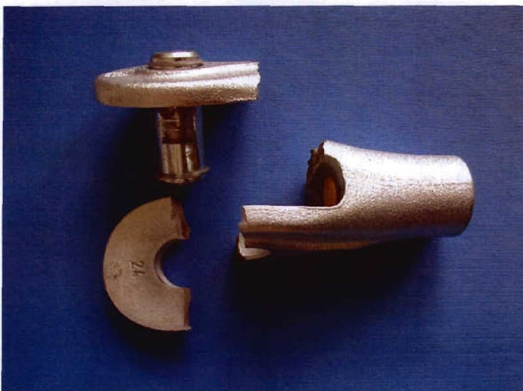
Abbildung 7-5: Gebrochener Gabelkopf DETAN-S 24
