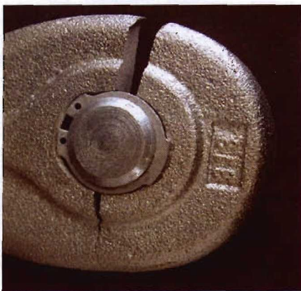
Abbildung 7-12: Angebrochener Gabelkopf; Zugstangendurchmesser: 36mm
