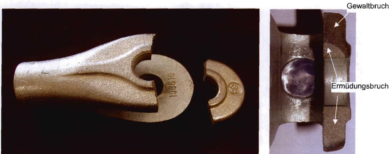
Abbildung 7-11: Gebrochener Gabelkopf; Bruchflächen
